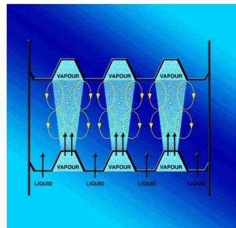
FIG. 2: CASALE-DENTE HIGH - EFFICIENCY TRAYS
