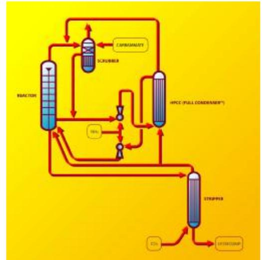
**Fig. 5 - Split Flow Loopä configuration**
